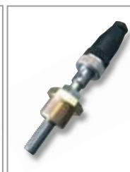
Sensore di prossimità induttivo completo di connettore femmina M12, 4 pin, IP67, a cablare, con ghiera montaggio M18 x 1 - Alimentazione 12/24 VDC Inductive proximity sensor, c/w female connector M12 4 pin, IP67, field attachable, ring nut reduction M18 x 1 - Power supply 12/24 VDC
