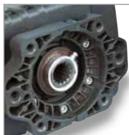
Predisposizione per motore idraulico SAE J744-C albero scanalato 14T 12/24 DP Hydraulic motor mount SAE J744-C spline shaft 14T 12/24 DP
